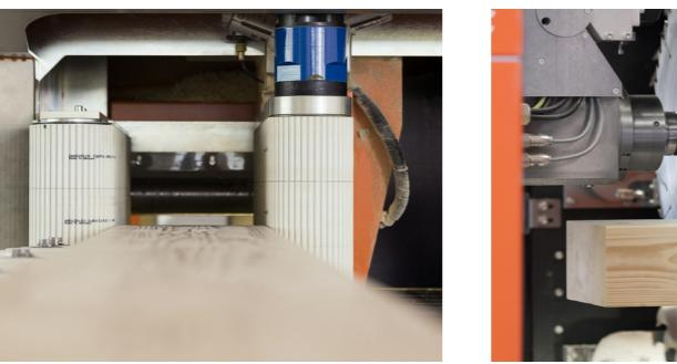
Riemenbatterie zur Bauteilförderung - 4-seitiger Antrieb, Messung und Klemmung ohne Umgreifen
