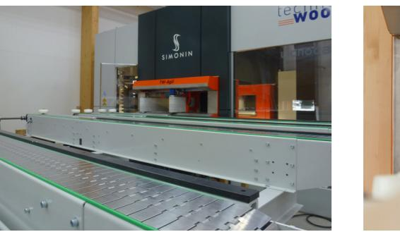
automatische Beschickung mit Vereinzelungsfunktion, individuelle Ausführung dank modularen Erweiterungen
