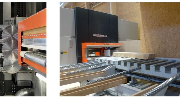
Effizienz dank 2-Kanal-Steuerung - eine Spindel arbeitet, die zweite Spindel wechselt das Werkzeug
