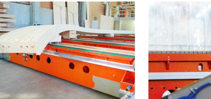
Die Förderung und Positionierung der Bauteile erfolgt mittels Portalwagen.
