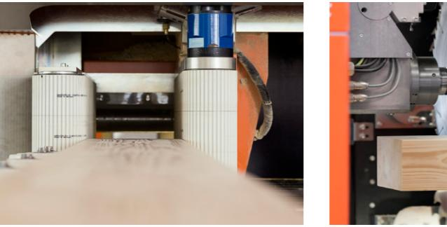
Riemenbatterie zur Bauteilförderung - 4-seitiger Antrieb,
