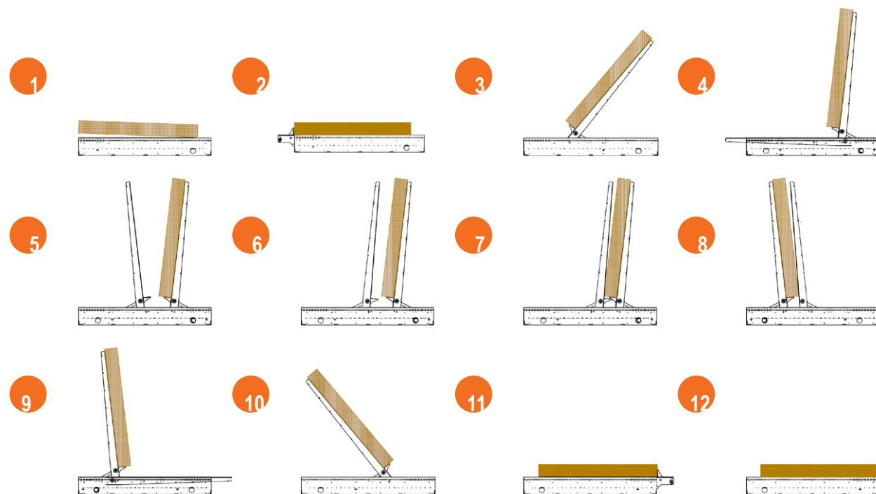
Die ersten Hebel des Systems klappen einen Anschlag aus und richten das Bauteil ab dem Bearbeitungstisch auf (Abb.: 1-4). Die zweiten Hebel fahren aus und werden zum Element hin bewegt (Abb.: 5-7). Das Element wird auf diesen zweiten Hebel übergeben und auf die andere Seite gefahren (Abb.: 8). Der erste Hebel wird eingefahren und der zweite Hebel legt das Bauteil ab und positioniert dieses auf dem Bearbeitungstisch (Abb.: 9-12).
