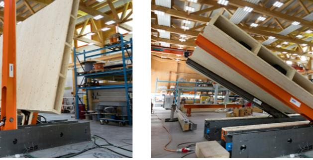
Aufricht-Modus ermöglicht ein sicheres Anhängen an den Hallenkran
