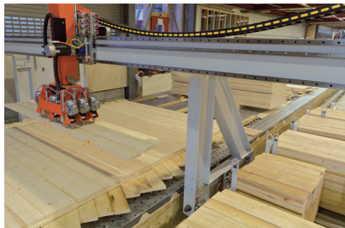
nach Längen sortierte, rohe Bretter les planches sont triées selon leur longueur the planks are ordered by length
