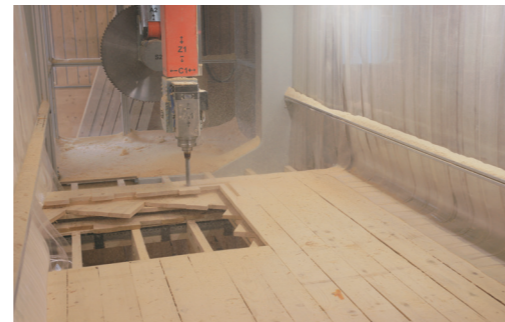
Zuschnitt eines TWOODS-Elements la coupe de l'élément en bois massif the pre-cut of a wooden element
