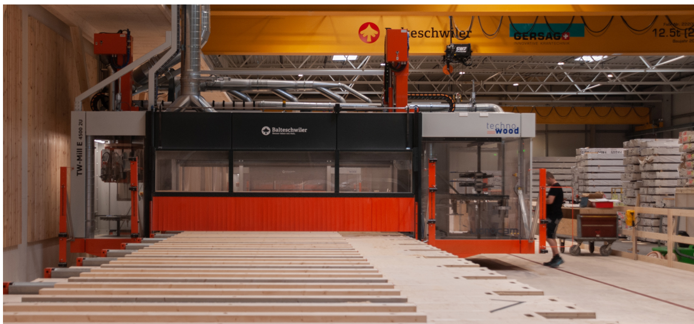
Die Portale TW-Mill E und TW-Mill M ermöglichen der Balteschwiler AG vielfältigste Bearbeitungen bis zu einer Plattendicke von 1.2 m
