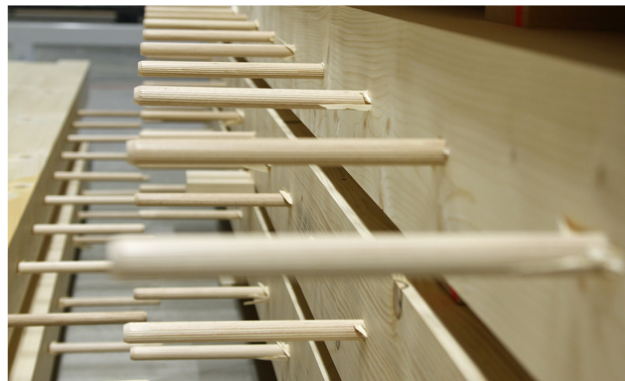
Die Brettstapelelemente für die Decken werden leimfrei mit Holzdübeln verbunden.
