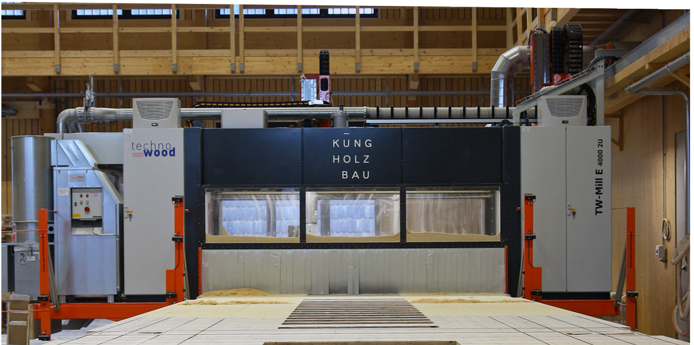
Auf der neuen Anlage TechnoWood TW-Mill E 4000 2U werden die Brettstapelelemente des Vollholz-Systems bearbeitet.
