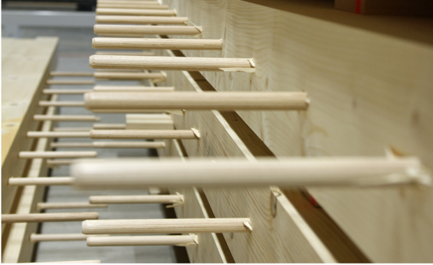
Les éléments d'empilage de planches pour planchers sont assemblés au moyen de chevilles en bois et sans colle.
