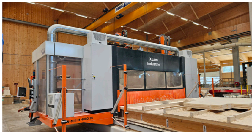
Diese Abbundanlage von Technowood bestückte Oertli mit Hochleistungswerkzeugen der jüngsten Generation
