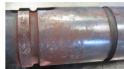
Erhöhte Vibrationen bei der Bearbeitung
