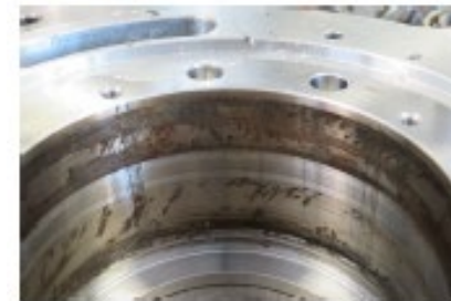
Ablagerungen von verschmutztem Kühlwasser
