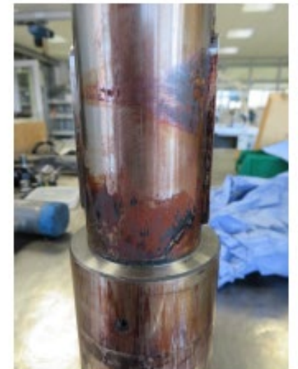
Ablagerungen von verschmutztem Kühlwasser
