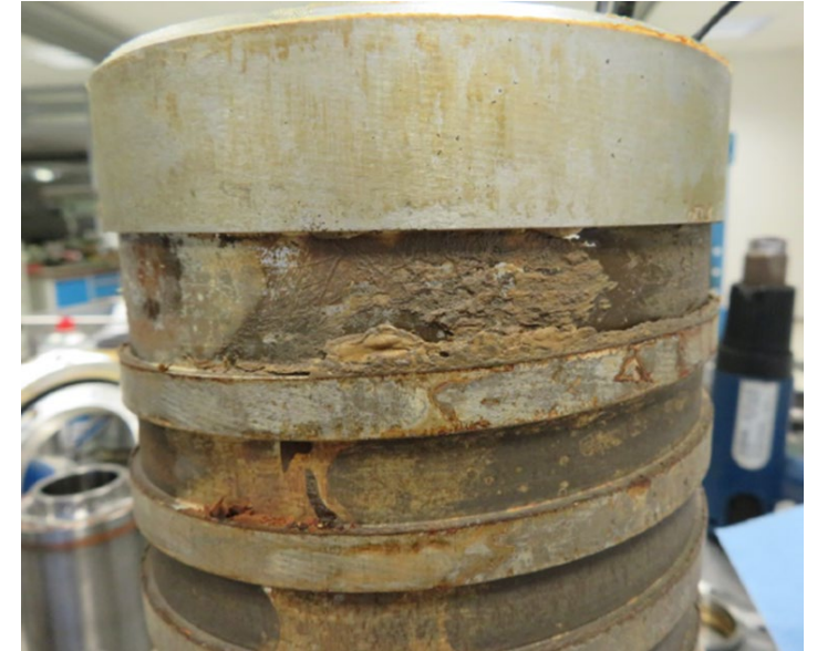
Ablagerungen von verschmutztem Kühlwasser
