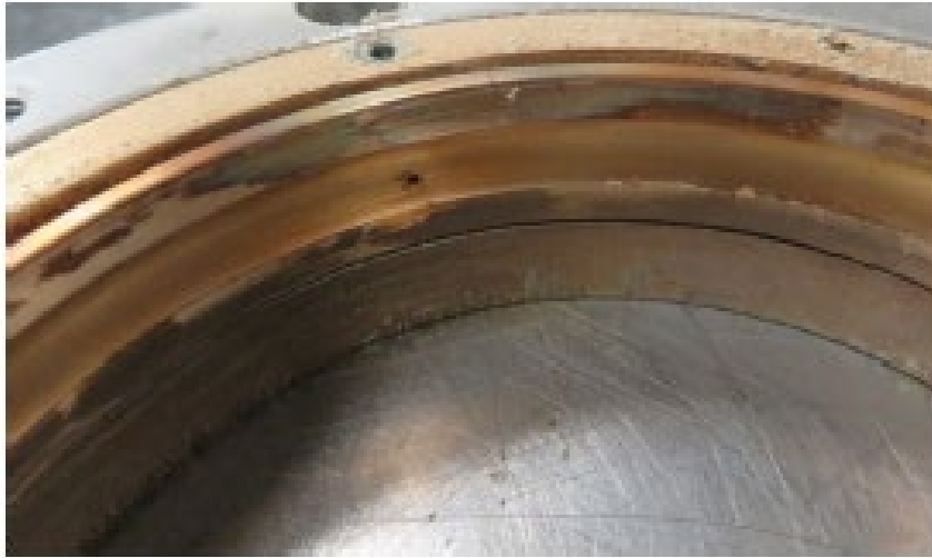
Lagerschaden / Messingschleifspuren durch stehenden Sperrluftring
