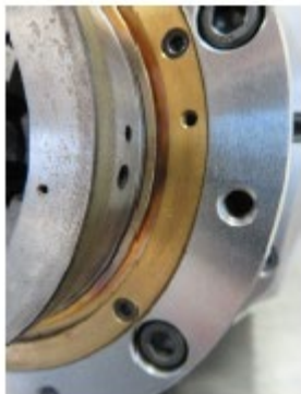
Folgeschäden, wenn bis zur totalen Zerstörung gearbeitet wird (Wellenbaugruppe)
