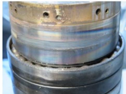
Folgeschäden, wenn bis zur totalen Zerstörung gearbeitet wird (Wellenbaugruppe)
