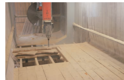
Zuschnitt eines TWOODS-Elements la découpe de l'élément en bois massif pre-cutting the wooden element
