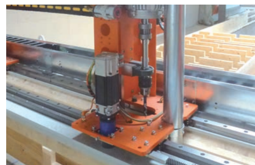
Löcher werden gebohrt und Dübel eingepresst des trous sont perforés et des chevilles insérées the drilling unit with guided auger bit
