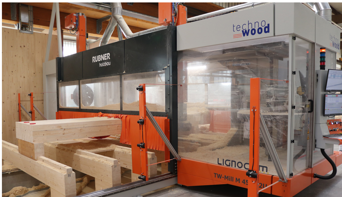
Die TW-Mill M 4500 2U: Die zwei Spindeln im Portalroboter bearbeiten die aufgelegten Werkteile in hoher Qualität und dank leistungsstarker CNC-Steuerung mit ebensolcher Flexibilität
