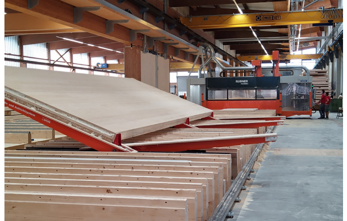
Die TW-Concept Line von TechnoWood: Die Fertigungslinie besteht aus verschiedenen Komponenten, welche beliebig zusammengestellt werden können. Im Bild das Wendesystem beim Arbeiten.
