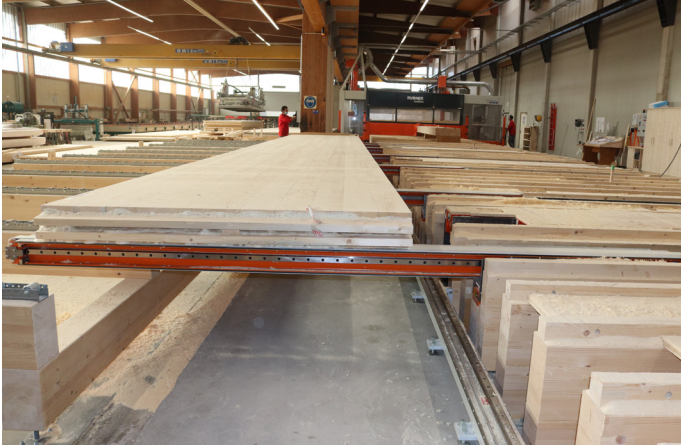
BSP-Elemente gelangen direkt aus der Produktion auf die sehr kompakte Fertigungslinie. An der Kopfseite wird BSH in die Linie eingebracht.
