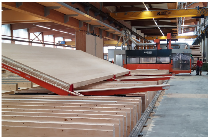
La TW-Concept Line de TechnoWood: la ligne de fabrication comprend différents composants pouvant être assemblés sur demande.
