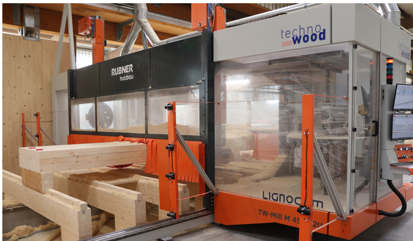
La TW-Mill M 4500 2U: les deux broches sur le robot à portique usinent les pièces de grande qualité avec une flexibilité maximale grâce à la commande CNC performante
