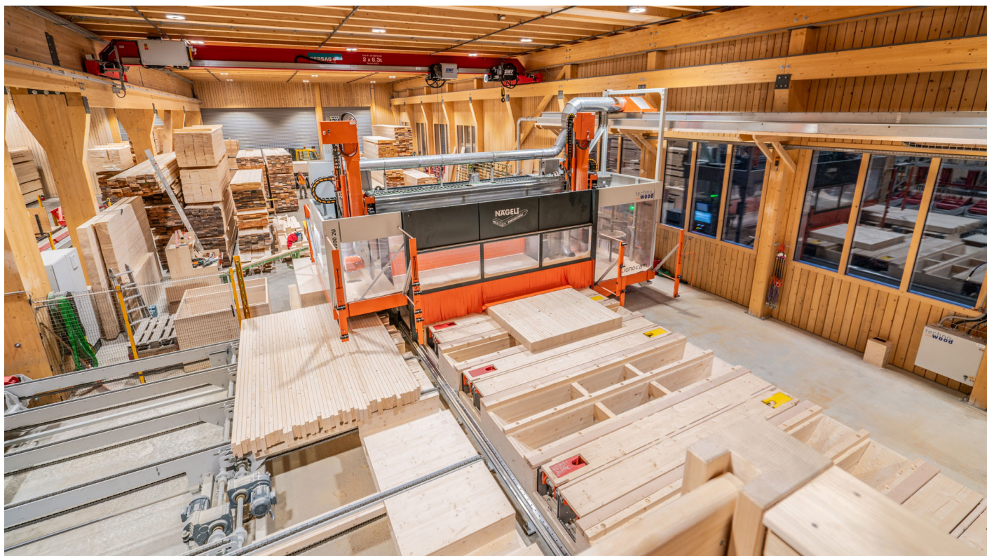
Die Werkhalle von innen mit der TW-Mill E
